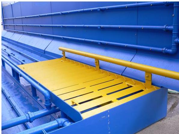
El equipo también dispone de un sistema de autolimpieza para eliminar los lodos que se han decantado en la plataforma durante el proceso de lavado de ruedas.
