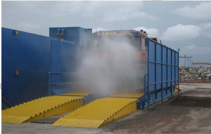
Así se ha conseguido un equipo capaz de soportar las más exigentes condiciones de trabajo, soportando puntas de más de 1000 camiones diarios en algunas ocasiones. Más de 7000 kg de estructura de acero garantizan la resistencia mecánica de la plataforma.
